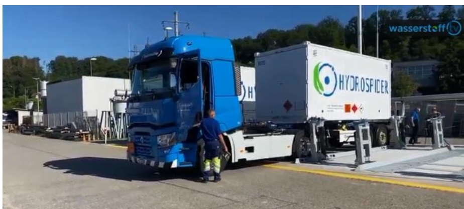
Figur 5.5. Container med vätgas lastas på lastbil för distribution (bild från film Wasserstoff.TV, 2020).
