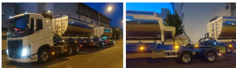
Figur 7.3 Ett asfaltsekipage med två linkar, benämns Citylink (Foto: TFK).
