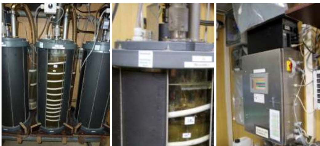
Figur 1.7. Lfl:s biogaslab i Freising, utrustning för kontinuerliga utrötningsförsök (Foto: David Ljungberg).
