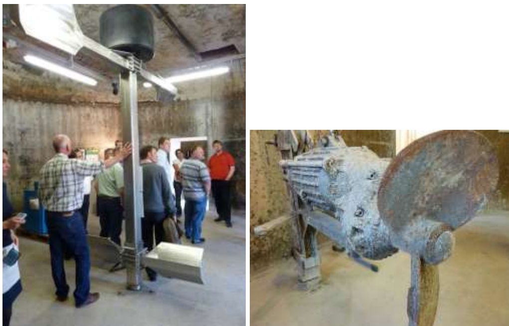
Figur 1.4. I röt-kammaren i visningsanläggning på Triesdorf lantbruksskola, t.h. en dränkbar omrörare (Foto: Carina Gunnarsson).
