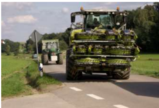
Figur 1.16. Den självgående exakthack som användes vid skörd av majs vid transport mellan två fält (Foto: David Ljungberg).
