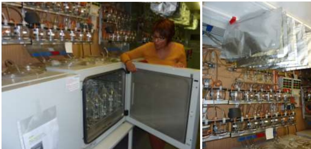
Figur 1.6. Lfl:s biogaslab i Freising, utrustning för satsvisa utrötningsförsök (Foto: David Ljungberg).
