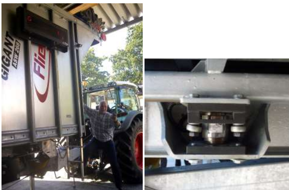
Figur 1.5. Transportvagn med inbyggda våceller för vägning av grönmassa (Foto: Carina Gunnarsson)
